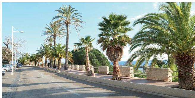
Construction d'un muret en béton désactivé, remplaçant les potelets et barrières pour sécuriser le cheminement piéton + remplacement des mâts d'éclairage public à basse consommation
